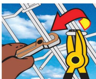
Em caso de necessidade, a emenda de telas pode ser feita amarrando-se todos os fios da tela utilizando-se do arame galvanizado Morlan BWG 14.
