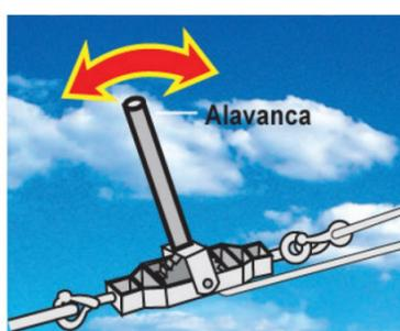
Proceda o esticamento da tela utilizando-se de um esticador de catraca posicionado na extremidade oposta da amarração inicial da tela. Cuidado ao tracionar a tela.
