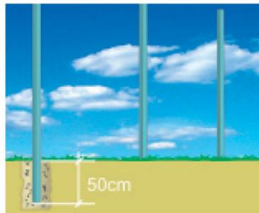
Cavar buracos com profundidade de 50 cm para colocação dos mourões de concreto ou madeira. Deve-se prestar atenção ao alinhamento e a altura dos mourões.
