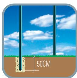
**1** Cavar buracos com profundidade de 50 cm para colocação dos mourões de concreto ou madeira. Deve-se prestar atenção ao alinhamento e a altura dos mourões.
