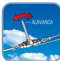
**5** Proceda o esticamento da tela utilizando-se de um esticador de catraca posicionado na extremidade oposta da amarração inicial da tela. Cuidado ao tracionar a tela.
