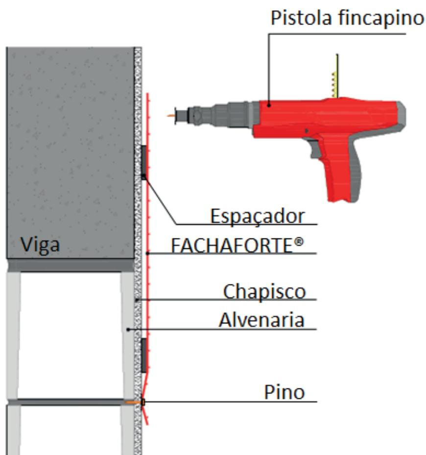
Fig. 23 - Posicionamento e fixação da **Fachaforte Morlan**® (Corte)
