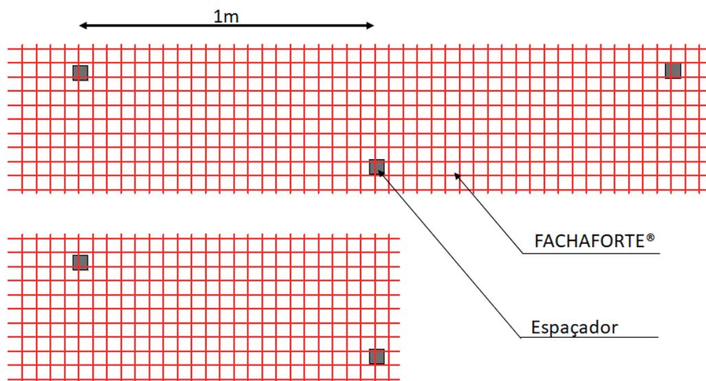
Fig. 14 - Posição dos espaçadores nas diagonais
