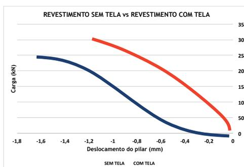
A **Fachaforte Morlan**<sup>®</sup> é a única tela testada para prevenção de fissuras em revestimento, e também a única tela do mercado que atende os requisitos da nova norma de revestimento de fachada, NBR 13.755, que descreve a necessidade de uma galvanização pesada nos arames que compõem as telas metálicas utilizadas na fachada de modo a garantir a durabilidade esperada para esse material.
