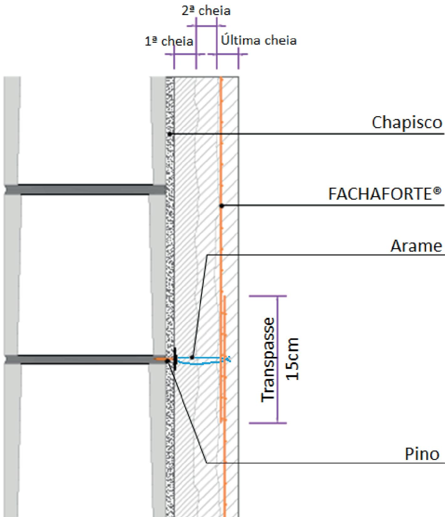
Fig. 29 – Posicionamento e fixação da tela de estruturação
