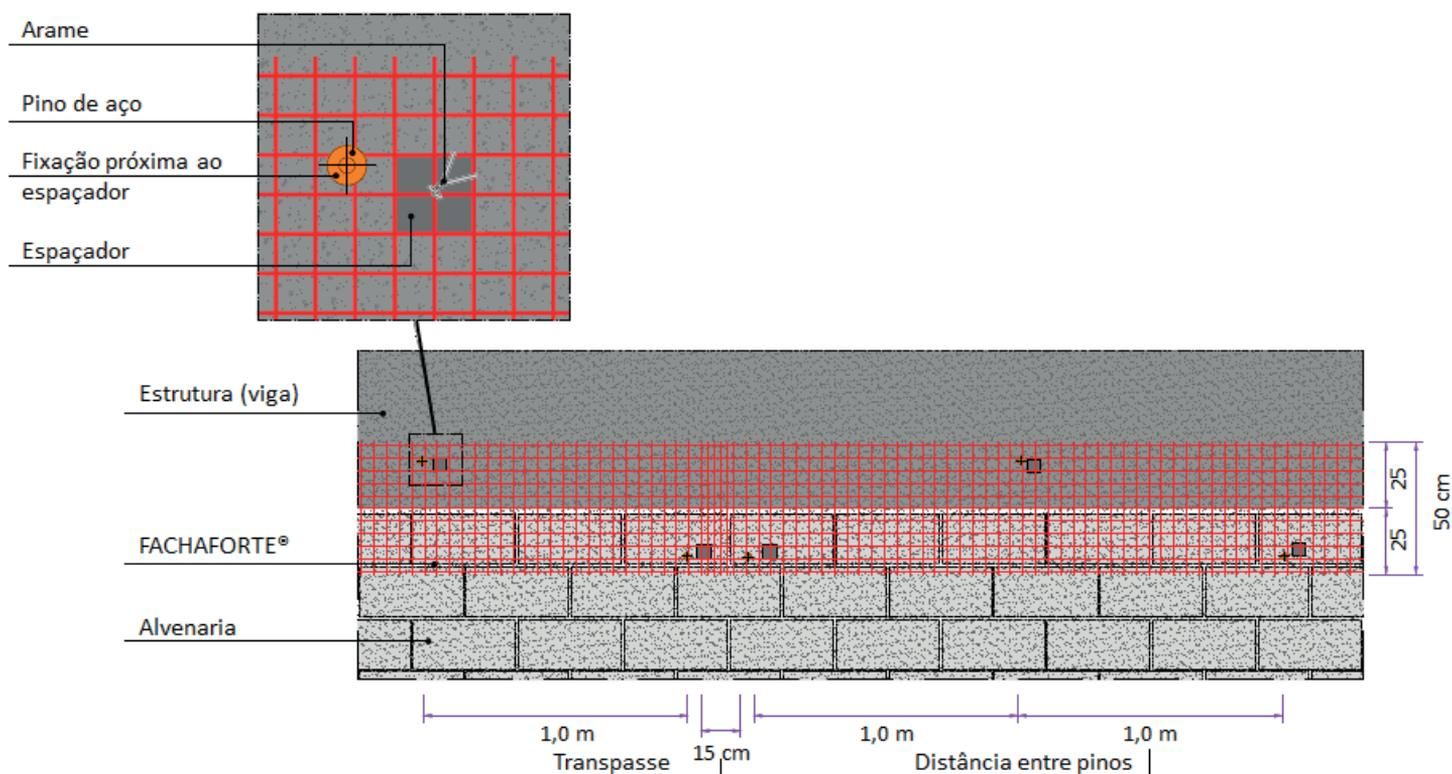
Fig. 19 - Posicionamento e fixação da **Fachaforte Morlan®** (Vista)
